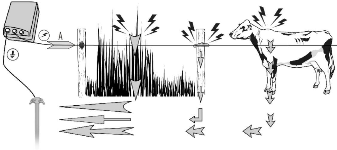
Le courant part de l'électrificateur, et circule dans le fil de clôture à la recherche de tout chemin de retour possible vers la terre.
