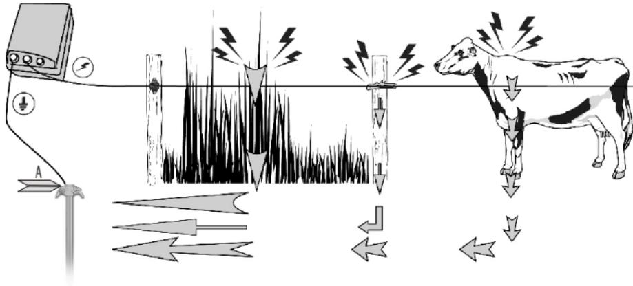
La corriente sale del electrificador, y circula en el hilo de la cerca en busca de cualquier camino de regreso hacia la tierra. El regreso a la tierra puede hacerse a través de las hierbas, de un aislador defectuoso, de un animal tocando la cerca, etc...
