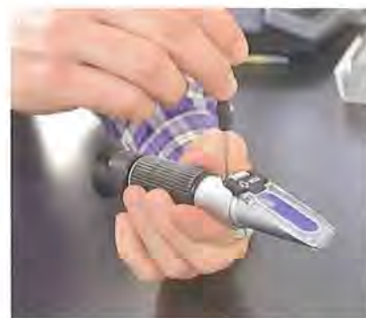
Mit dem Schraubenzieher wird das Gerät kalibriert. Dafür muss man durch das Okular blicken und die Skala «nullen».
